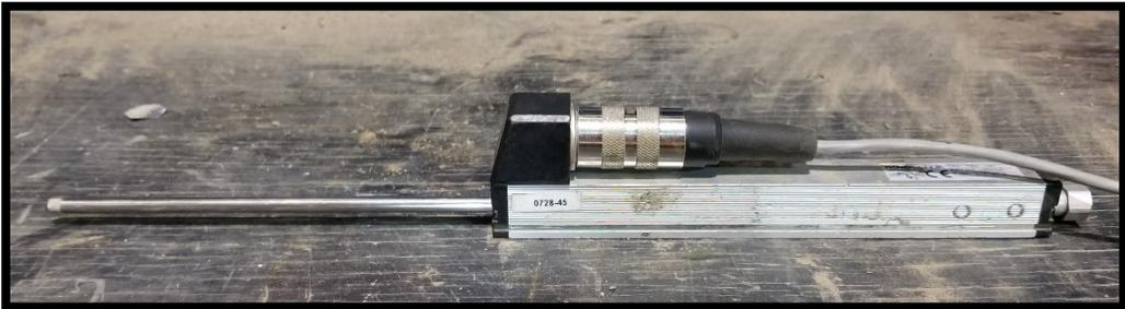
**FIGURE 2.34: TRS-100 POSITION TRANSDUCER**
