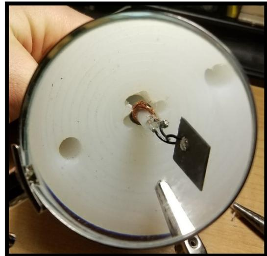
**FIGURE 2.14: BENDER ELEMENT SHOWN BEFORE BEING HOUSED (MOAT NOT CUT YET)**
